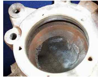
未使用Glystantin的水泵
