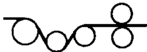
图 2 S 3 P 型：三个 S 辊和一对压力辊
